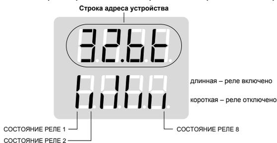
Рисунок 9 – Пример табло при просмотре состояний реле БК
