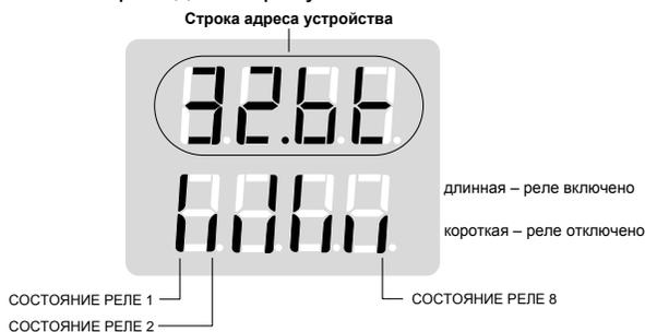
Рисунок 11 – Пример табло показывающего прибора при просмотре состояний реле БК
