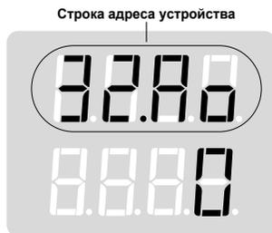
Рисунок 10 - Пример табло при просмотре адреса, по которому произошло последнее срабатывание реле
